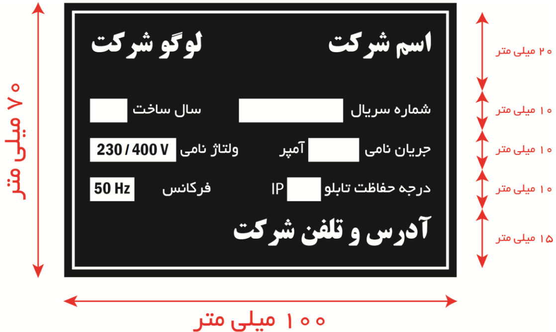
شکل (پ ۵): نمونه پلاک مشخصات تابلو
